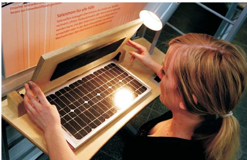
Lichtenergie lässt Elektronen fließen – in der Ausstellung übernimmt eine Lampe die Funktion der Sonne.
